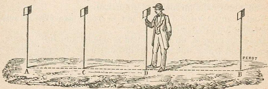
Fig. 18. — Jalonnement d'une direction par un arpenteur seul.
