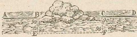
Fig. 23. — Prolongement d'un alignement au delà d'un obstacle.
